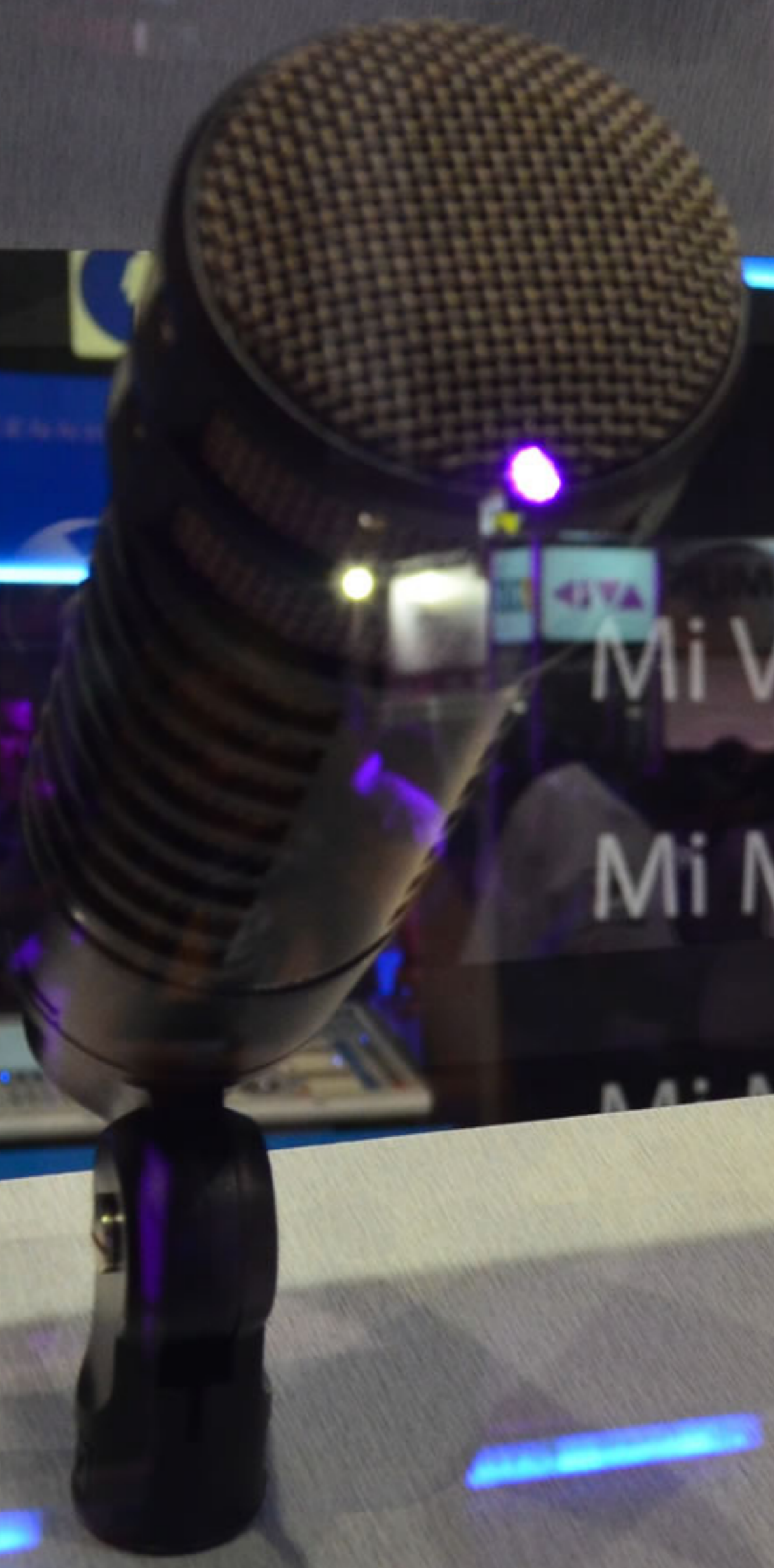
Ev RE320 • Dinámico Cardiode. • Tecnología Variable-D, para un mínimo efecto de proximidad. • Tecnología N/DYM con dos filtros seleccionables. • Respuesta de Frec. de 30 a 18000 Hz.
