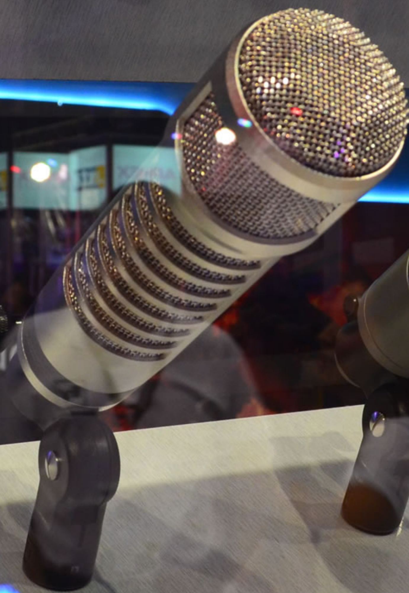
Ev RE27 • Dinámico Cardiode. • Tecnología Variable-D, para un mínimo efecto de proximidad. • Tecnología N/DYM con tres filtros seleccionables. • Respuesta de Frec. de 45 a 18000 Hz.
